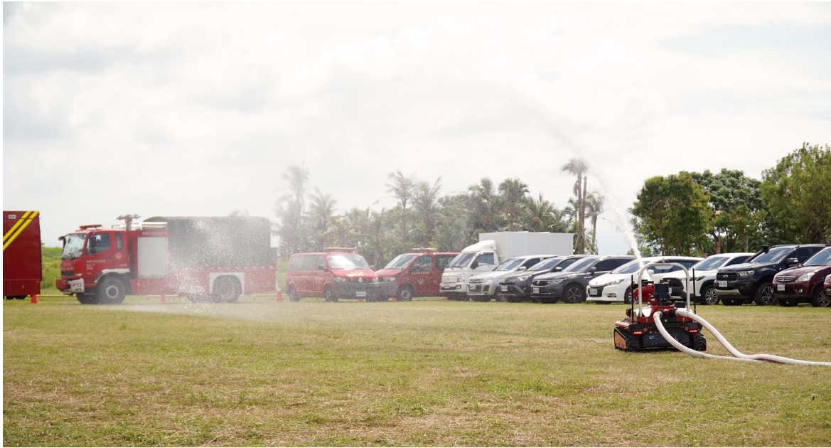
■ 圖 6、消防救災機器人現場展示噴水柱性能
